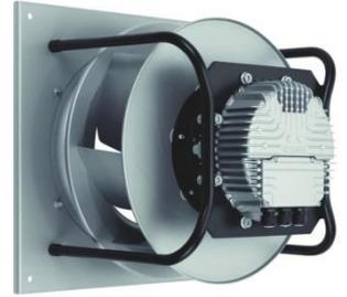
Les ventilateurs du type à réaction (aubes recourbées vers l'arrière) sont réalisés en tôle d'acier galvanisé, aluminium ou en matière synthétique. Sens de rotation droite, vu côté moteur (aspiration).
