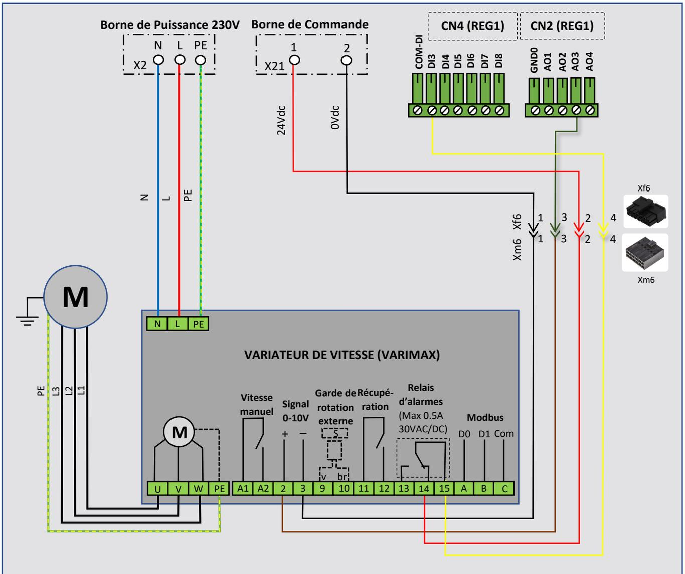
Le récupérateur d'énergie à roue à vitesse variable est un échangeur de type air/air dont le rôle est lors des périodes hivernales, de récupérer la chaleur contenue dans l'air évacuée des bâtiments pour réchauffer l'air froid extérieur introduit par le renouvellement de l'air.
